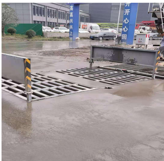
车辆冲洗平台
