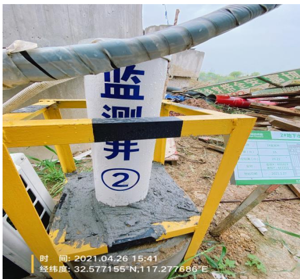
地下水监测井 2
