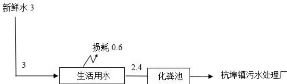
图 2-1 验收期间项目水平衡图 单位：t/d
